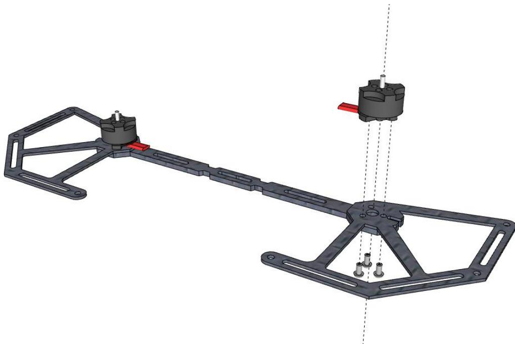
Установите защиту пропеллеров и двигатели на детали «Луч», используя крепеж M2.
