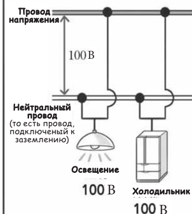
ОДНОФАЗНАЯ ДВУХПРОВОДНАЯ СИСТЕМА (100 В)
