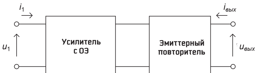
Рис. 6-A2 Каскадирование усилителя с ОЭ и эмиттерного повторителя
