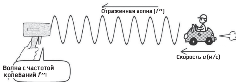
Рисунок 3. Эффект Доплера для ситуации, когда отраженная машиной звуковая волна воспринимается измерителем скорости
