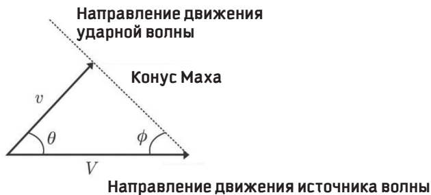
Рисунок 9. Угол, под которым наблюдается ударная волна
