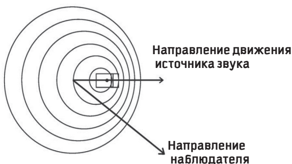
Рисунок 4. Эффект Доплера, когда направление движения источника звука и наблюдателя не совпадают
