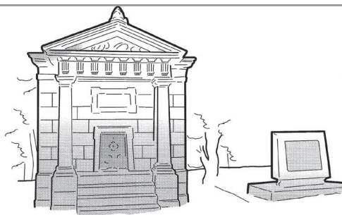
Рис. 1.6. Точки отсчета реперных точек и пунктов триангуляции
