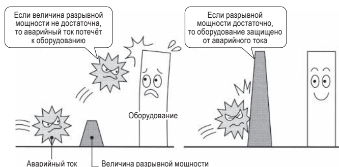
Рис. 4.1. Высокая и низкая разрывная мощность
