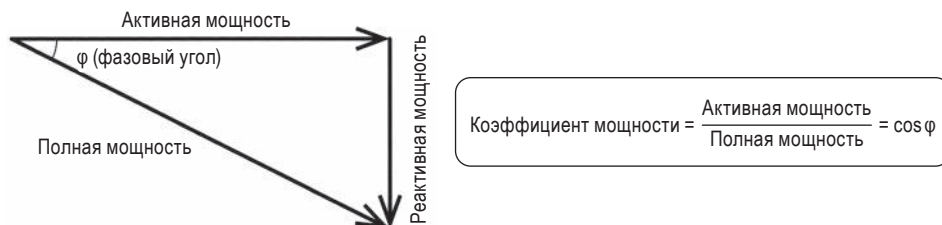
Рис. 4.4. Образование реактивной мощности
