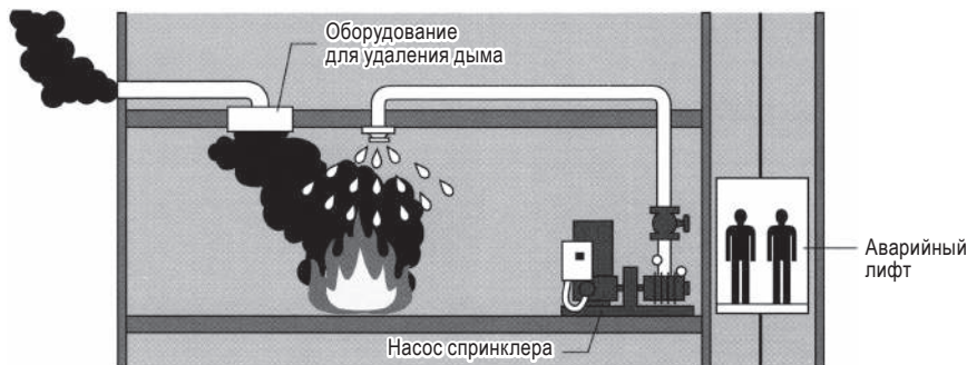
Рис. 3.4. Оборудование для защиты от стихийных бедствий, которое должно функционировать при отключении электроэнергии
